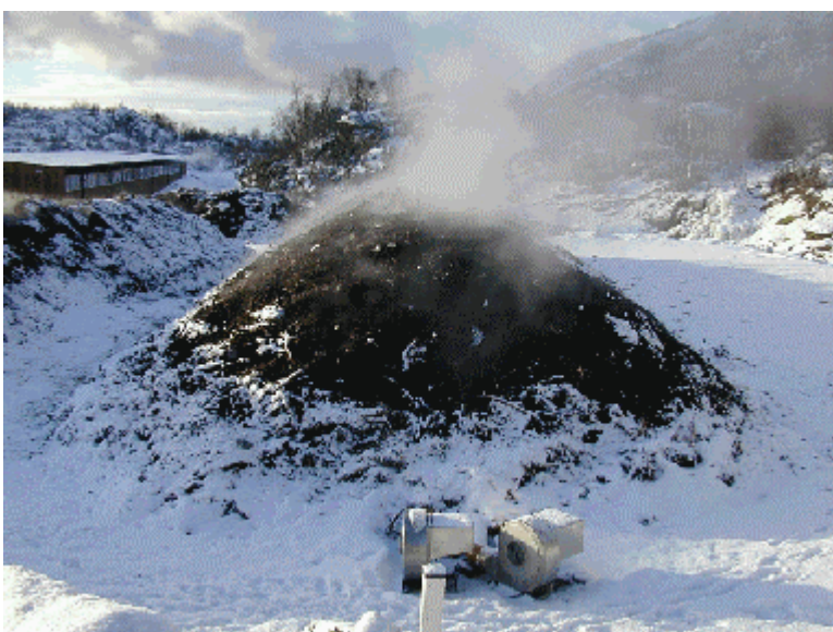
Bilde 6: Ferdig bygget storranke. Det er god avdamping når viftene går.
