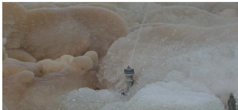
Figur 8 : Mamkad spaltdyse i drift i sterk kulde ved Lier avfallsfylling.
