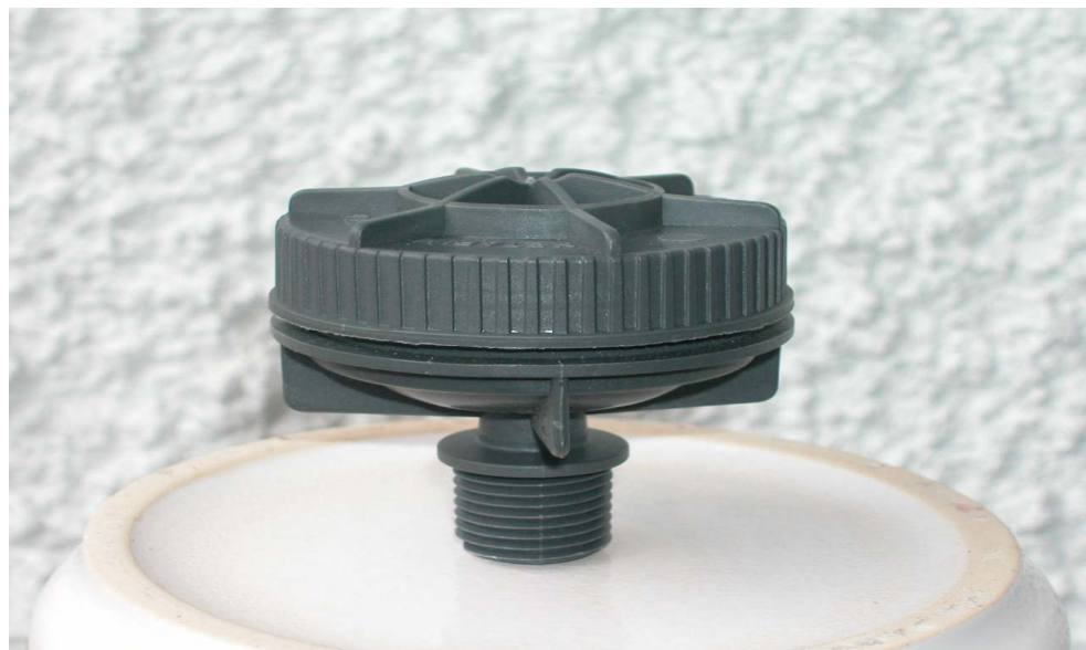
Figur 4 : Automatisk spyleventil for dryppslanger. Ventilen sørger for gjennomspyling av slangen hver gang pumpa starter. Ventilen hindrer også sand i å blokkere labyrinten under drypphullene.
