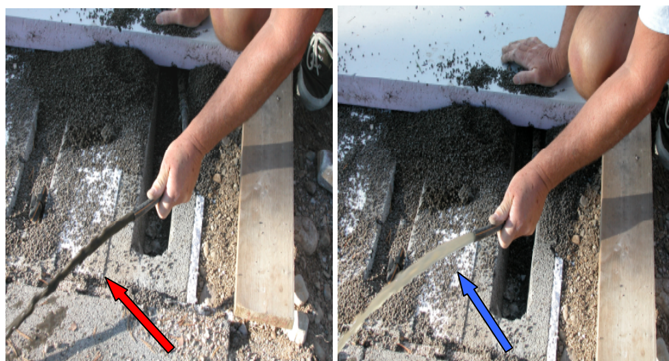
Figur 2 : Opphopning av slam i dryppslanger som belastes med dårlig avslammet vann. I slangen til venstre spyles slammet ut etter ca 1½ års belastning (rød pil). Slangen til venstre viser vannet slik det ser ut når det kommer fra slamavskilleren (blå pil).
