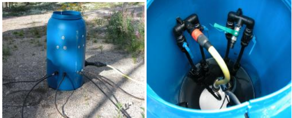
Figur 10 : Prototyp på pumpekum for dryppslangeanlegg bygget for testing av anleggene på feltstasjonen i Rena rensepark. Prototypen er videreutviklet og satt i produksjon av Dryppvanning AS.
