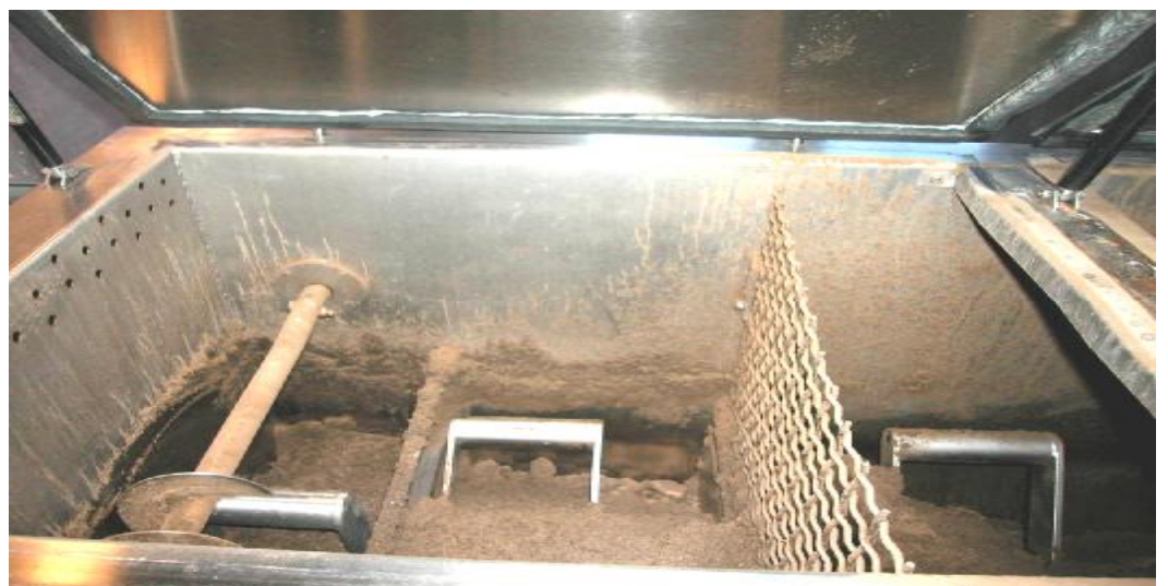
Figur 7 : Interiør fra komposteringsreaktoren som er utprøvd på Bjørkelangen. Kompostering prosessen akselereres med tilsetning av komposteringsbakterier og varme.
