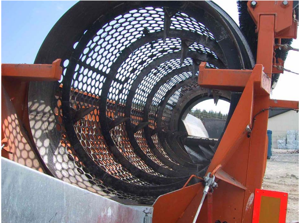
Figur 3. Trommelsikt med kniver på GLØR-anlegget.
