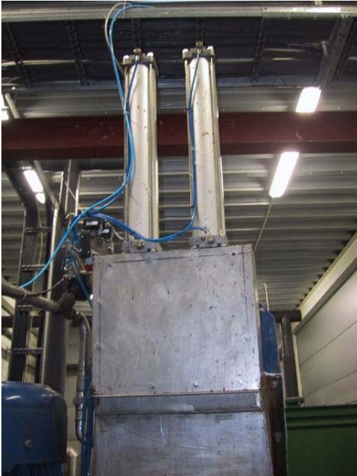
Figur 10. Hydrauliske "stampere" på topp av kvern for matavfall.
