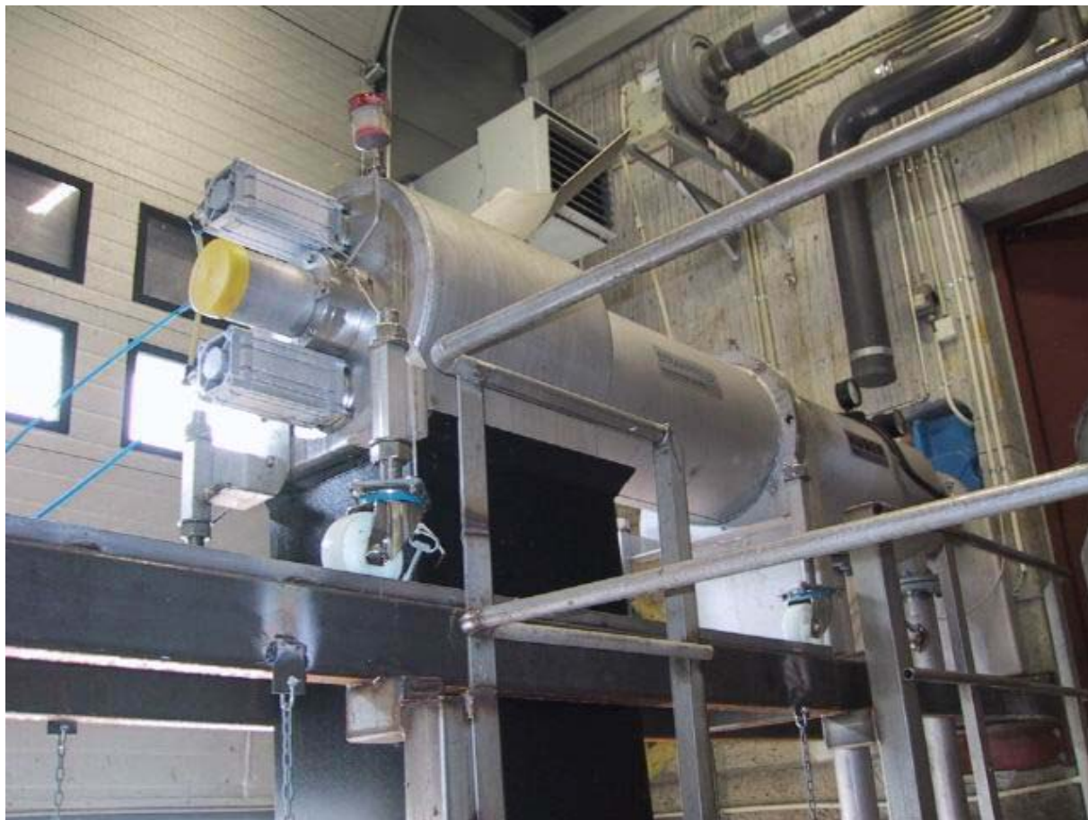
Figur 8. Strainpress fjerner effektivt plast og fiber.
