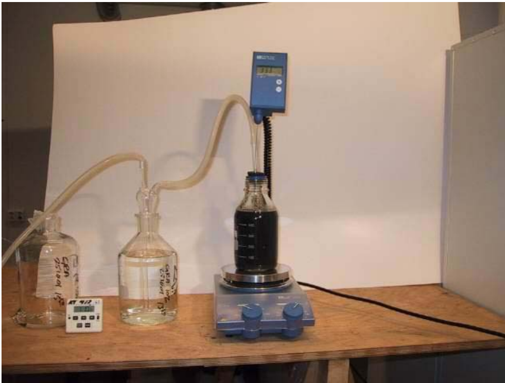
Figur 3.1 Testoppsett for måling av gassproduksjon ved anaerob lagring av utråtnet slam
